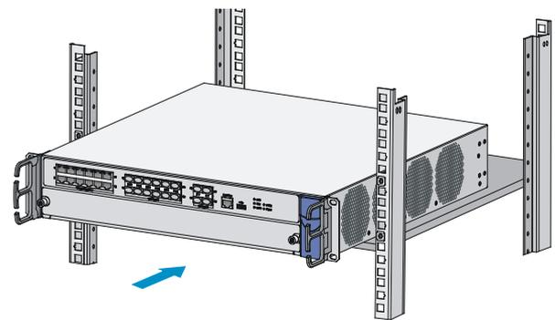
将设备安装进机柜中，用M6机柜螺钉将设备固定在机柜上。
