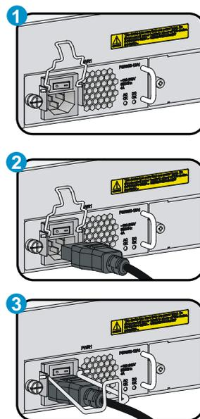
连接直流电源线。
